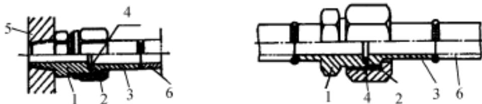
图 6-21 焊接式管接头
